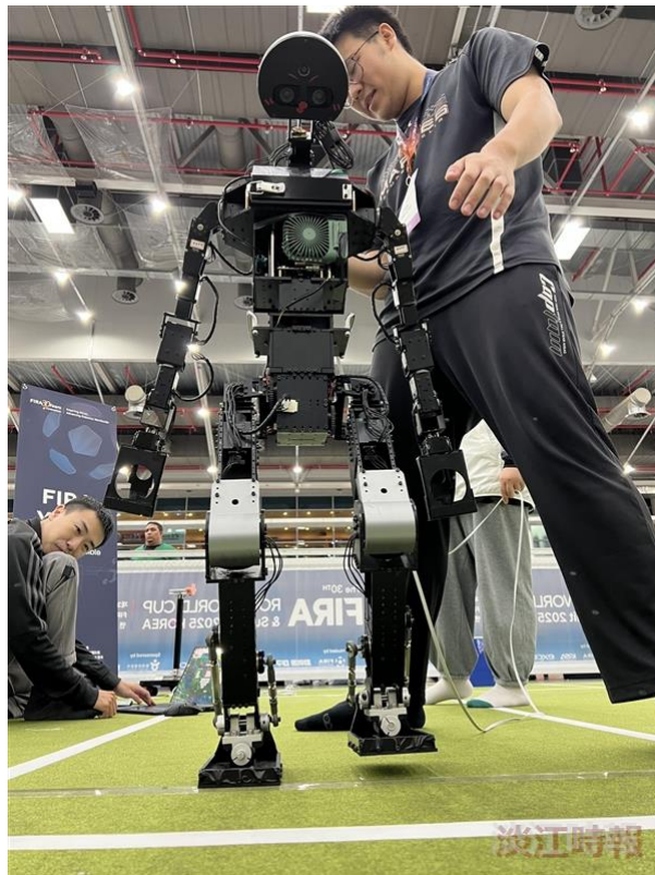
大型人形機器人的步態測試。(圖／電機系提供)
