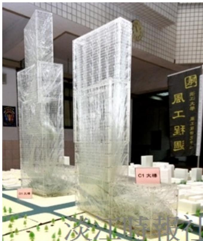
【記者張家綺淡水校園報導】風工程研究中心於上月28至30日「風洞週」，特別在新工學大樓3樓舉辦展示活動。今年特別展出代表性建築物，如台北車站雙子星大樓模型及半徑450公尺的景觀也按比例縮小為模型景觀一部分。風工程中心主任鄭啟明表示，為測試風向、風速對於高層建築物的各項影響，建築模型表面佈置數百個感應器，在實驗時將此模型放入風洞中，實驗後所得數據作為未來建築設計的依據。（&#20931;嘉翔攝）
